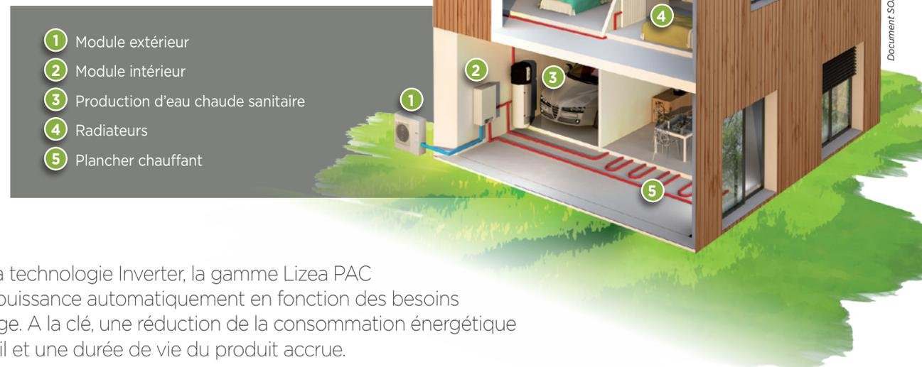
Dotée de la technologie Inverter, la gamme Lizea PAC adapte sa puissance automatiquement en fonction des besoins de chauffage. A la clé, une réduction de la consommation énergétique de l'appareil et une durée de vie du produit accrue.
