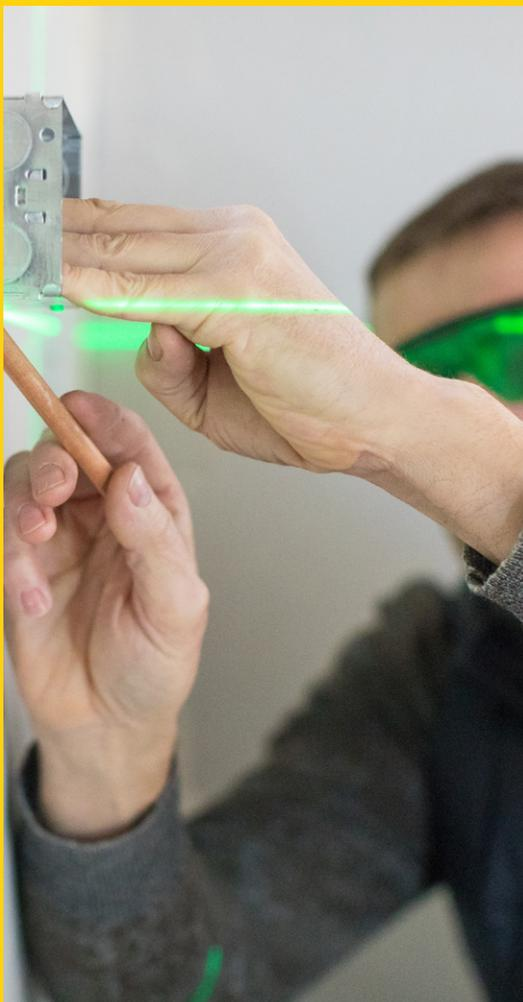
L'ancienne technologie utilisée sur le marché consistait à filtrer le faisceau rouge deux fois à travers des cristaux pour ressortir vert. Ce processus entraînait un dégagement de chaleur et une forte consommation d'énergie. La nouvelle technologie, dont **STANLEY** a été précurseur, se base sur une diode qui génère directement un faisceau vert à partir du semi-conducteur.
