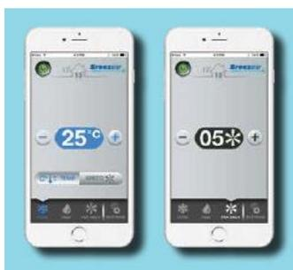
Afin de faciliter son utilisation, le nouveau Climate Wizard CW3 est compatible avec la suite MagIQtouch créée par SEELEY International. Cette solution peut notamment intégrer deux sondes de température en intérieur et en extérieur ainsi qu'une application pour téléphone. Elle permet de contrôler et de programmer une installation en température et hygrométrie, ainsi que de récupérer des informations sur la température extérieure, de communiquer avec une GTC (Gestion Technique
