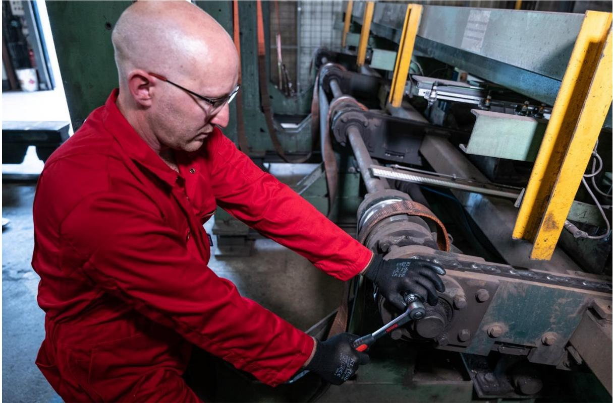
**MOB simplifie le travail des professionnels de la maintenance avec le nouveau Cliquet Fast. Conçu en France, le Cliquet Fast est une innovation en cours de brevet (patent pending) dotée d'une molette intégrée destinée à serrer avec rapidité, sans prévisage pour faciliter la pose de boulons.**
