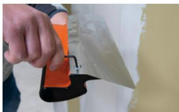
Que ce soit pour remplacer une lame usée, ou pour changer de modèle « lissage » ou « finition », les lames de l'Ergolame® sont interchangeables et cela très facilement grâce à une clé de serrage logée en permanence dans la poignée. De ce fait, il est possible d'avoir une lame de lissage et une lame de finition sur une seule et même monture.
