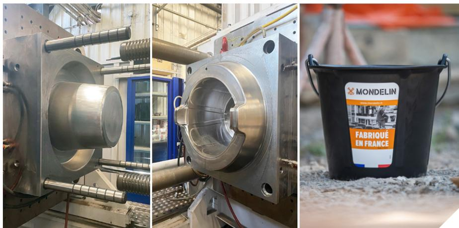
Mondelin mène plusieurs projets stratégiques pour renforcer sa production locale. D'une part, un projet significatif, avec l'arrivée d'un nouveau moule de 4 tonnes qui a permis de réinternaliser la fabrication des auges cabas au sein de son atelier d'injection.
