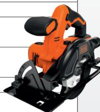
Dotée d'une semelle en métal avec visibilité, elle est performante et ultra précise pour effectuer les travaux de rénovation, le petit élagage et les coupes de tubes (PVC, cuivre, métal). L'angle de coupe en biais allant jusqu'à 45° et le diamètre du disque de 140 mm en font un outil polyvalent. Pensée pour assurer une sécurité maximale, la scie circulaire se bloque en cas de surchauffe.
